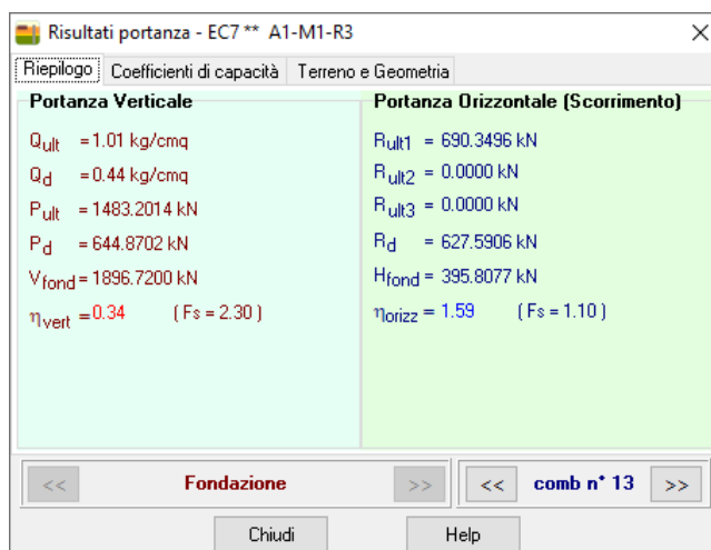
Figura 48 – Risultati della verifica di capacità portante, combinazione 13 (massima eccentricità longitudinale)
