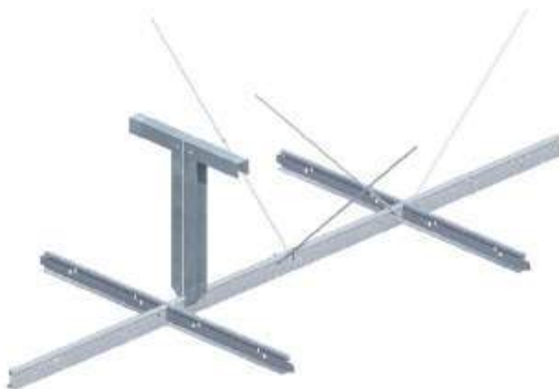
Fig. 2: Componenti in opera del sistema di controventatura.
